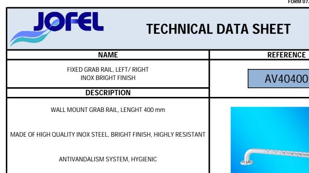
MANUFACTURED FROM STAINLESS STEEL TUBE 32 mm  $\emptyset$ , BRIGHT FINISH
