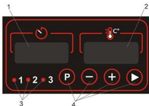
Рис. 3. Панель управления устройством 1 - дисплей таймера; 2 - дисплей температуры; 3 - индикаторы работы таймеров; 4 - кнопки управления.
