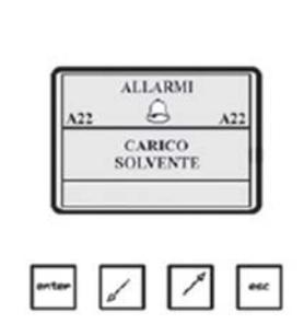
Данный предупреждающий сигнал блокирует выходы. При этом продолжают работать в обычном режиме входные отверстия баков и насоса растворителя, что позволяет оператору загружать растворитель в машину.
