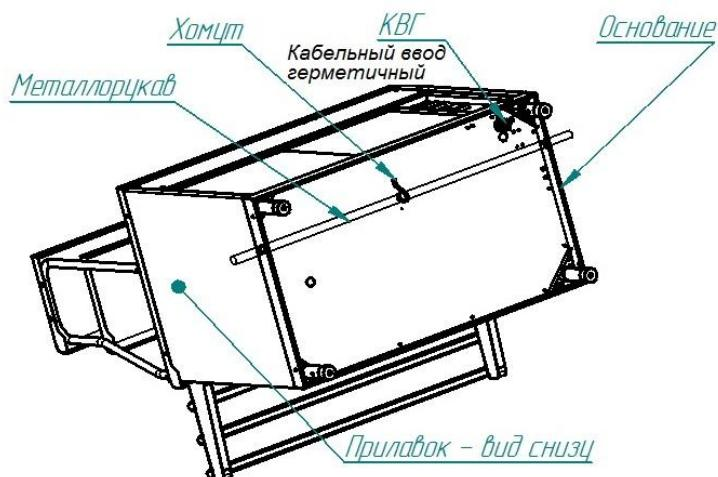
В основаниях изделий линии раздачи введено сквозное отверстие диаметром 29,5 мм и поддерживающие хомуты для возможности пропуска металлического гибкого рукава с питательными кабелями сквозь все изделия линии раздачи.
