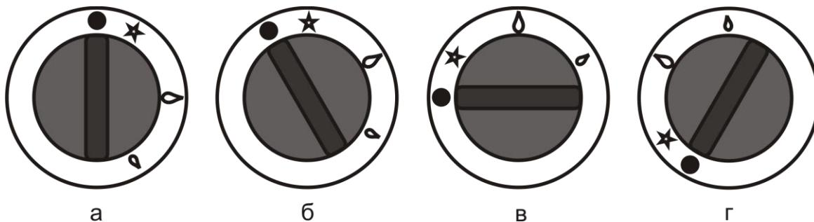
Рис. 2. Соответствие положения ручки крана режиму работы горелок
