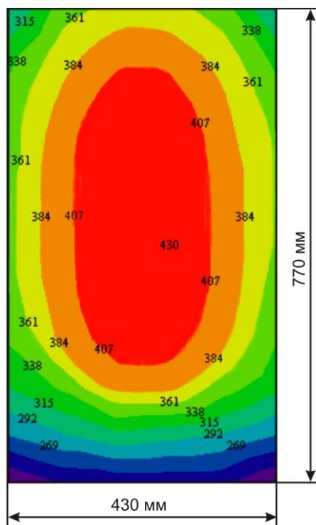
Рис.2. Градиент температуры поверхности закрытого пламени,  $^{\circ}\text{C}$
