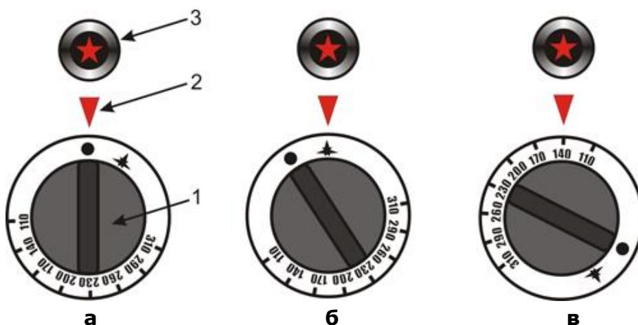
Рис.9. Положение ручки и режимы работы духового шкафа:
