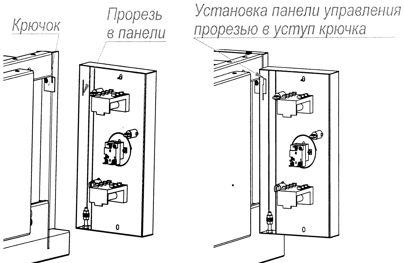
Рис.10 Схема установки панели управления при ТО
