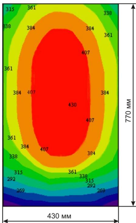
Рис.2. Градиент температуры поверхности закрытого пламени, °C
