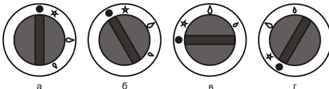
Рис.8. Соответствие положения ручки крана режиму работы горелок открытого пламени и горелок с закрытой поверхностью:
