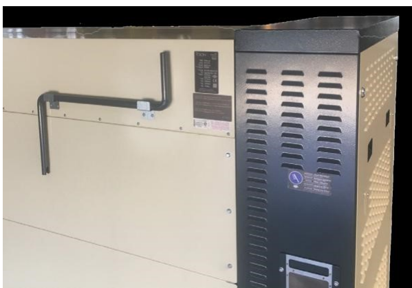
Фото 3 валоповоротная рукоять и ее подвеска
