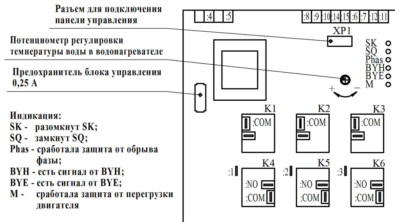
Рисунок 2 – Индикация цепей контроля и условное обозначение контактов блока управления
