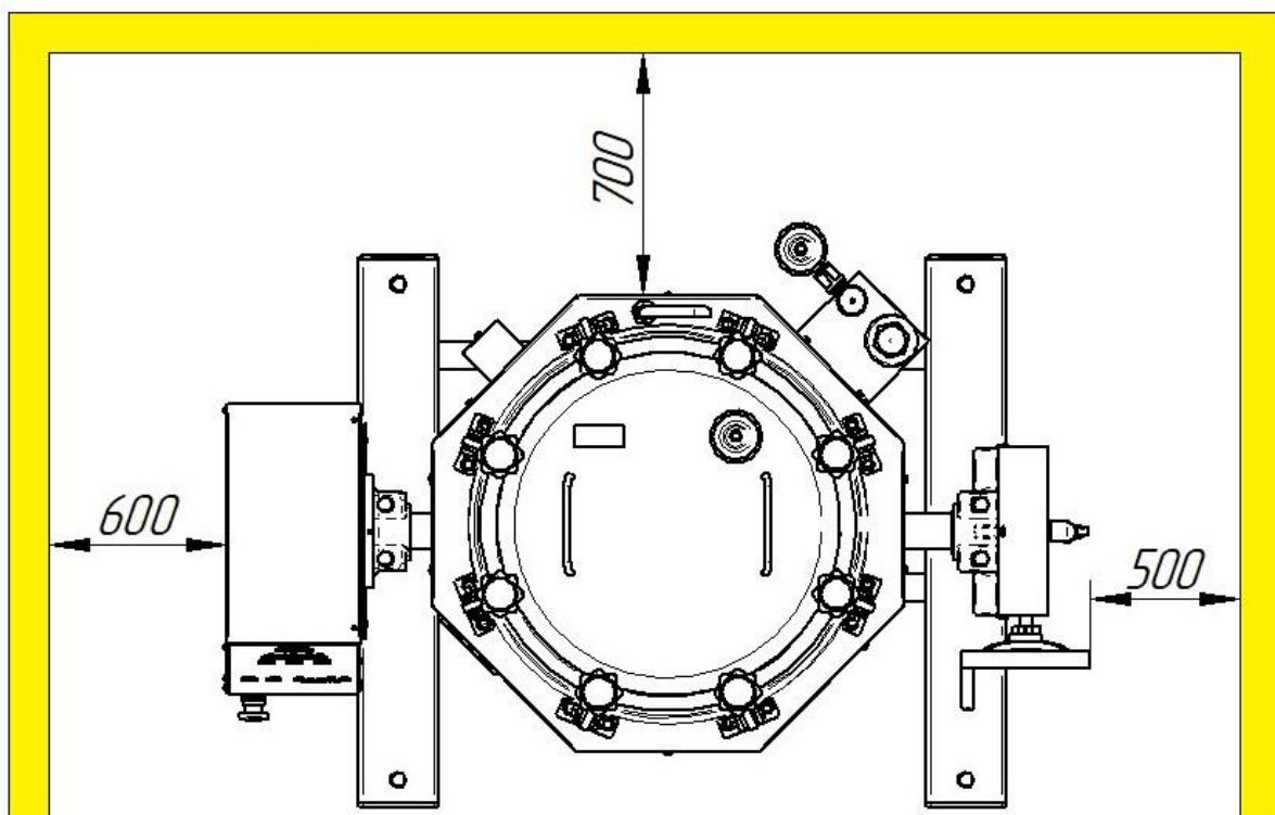
Рис. 3. Установка котла
