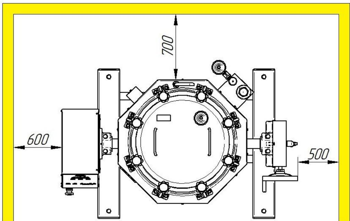
Рис. 3. Установка котла
