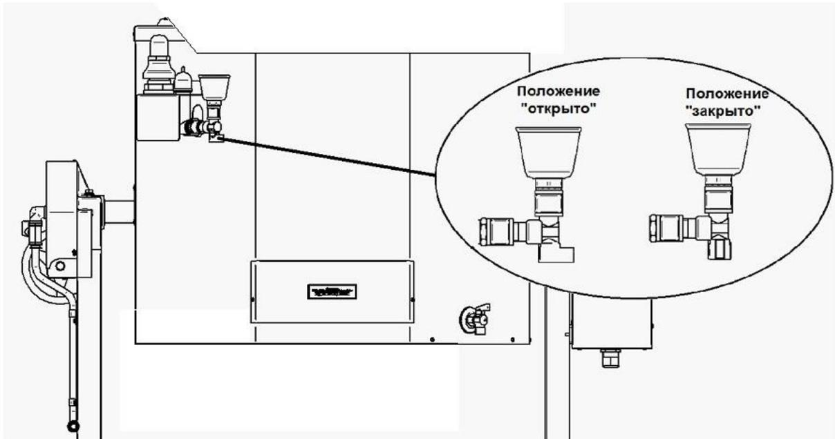
Рис. 8 Положение крана заливной воронки
