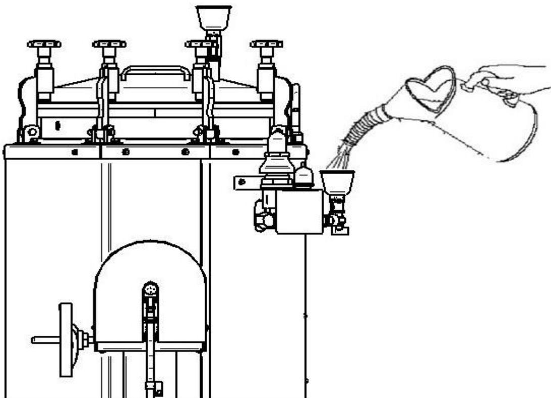
Рис. 9 Залив воды в «рубашку»
