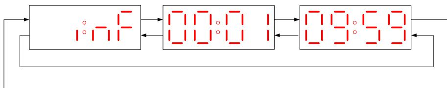
При запуске котла в работу со значением параметра «ТАЙМЕР» - «inF» работа продолжается без таймера и завершается нажатием и отпусканием кнопки «СТОП». Во время работы на индикатор выводится прямой отсчет времени, изменение значения параметра «ТАЙМЕР» недоступно.
