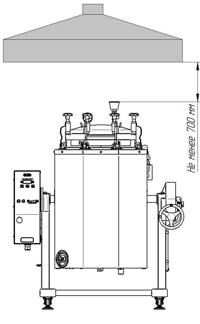
Рис.4. Установка котла под вытяжным зонтом
