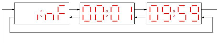
При запуске котла в работу со значением параметра «ТАЙМЕР» - «inF» работа продолжается без таймера и завершается нажатием и отпуском кнопки «СТОП». Во время работы на индикатор выводится прямой отсчет времени, изменение значения параметра «ТАЙМЕР» недоступно.
