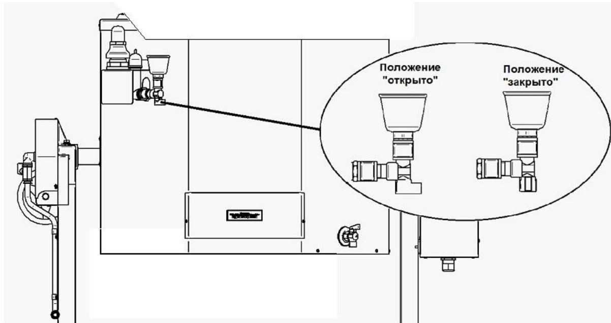
Рис. 8 Положение крана заливной воронки
