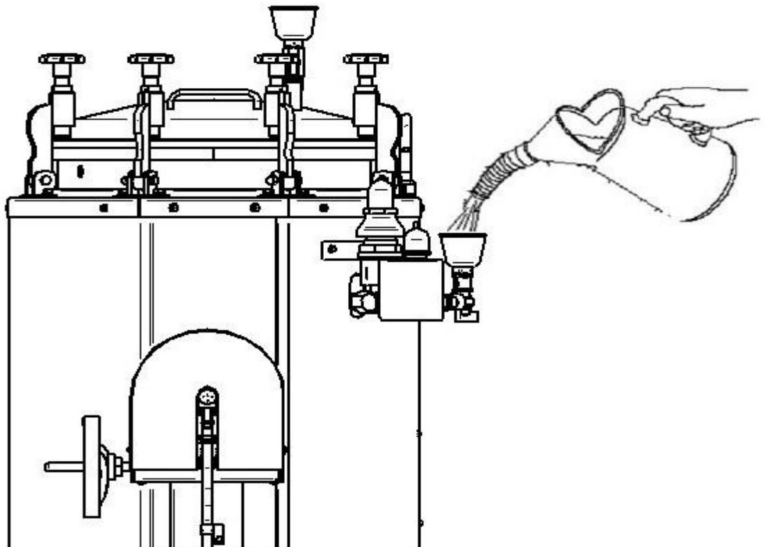
Рис. 9 Залив воды в «рубашку»
