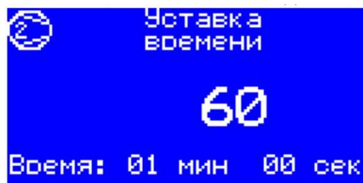
Рис. 9- Экран изменения уставки времени прохождения камеры
