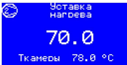
Рис. 8 - Экран изменения уставки температуры
