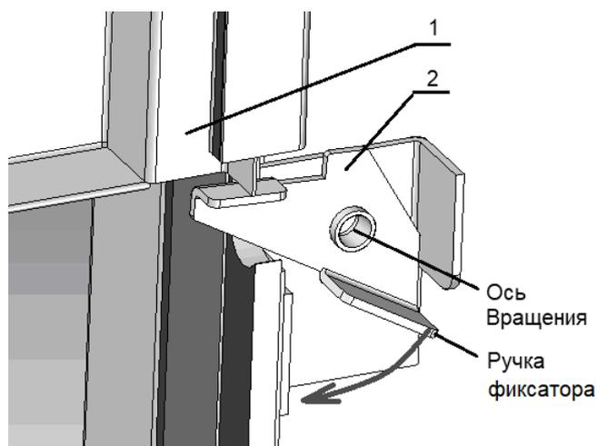
Рис. 2.2. Направление поворота фиксатора
