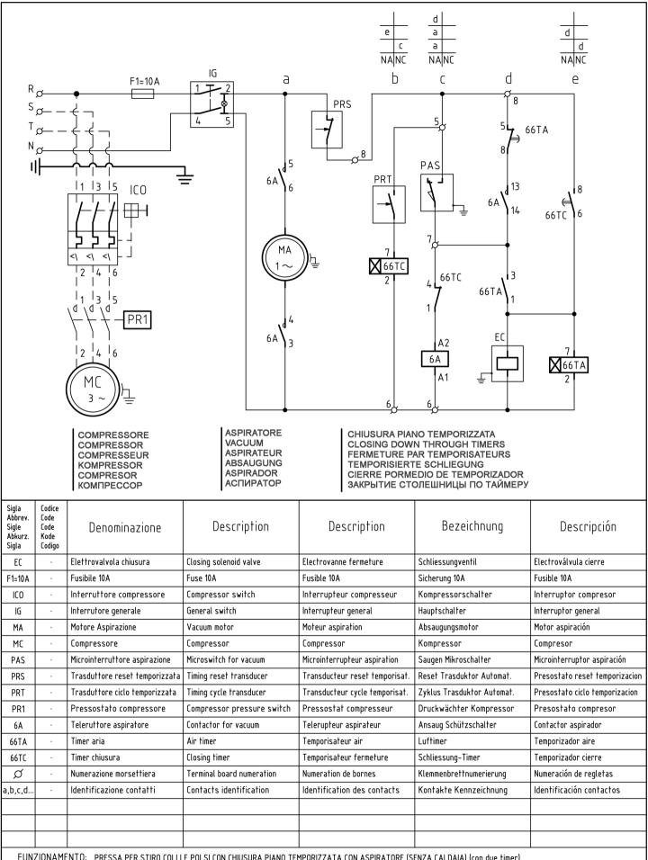
FUNZIONAMENTO: PRESSA PER STIRO COLLI E POLSI CON CHIUSURA PIANO TEMPORIZZATA CON ASPIRATORE (SENZA CALDAIA) (con due timer)
