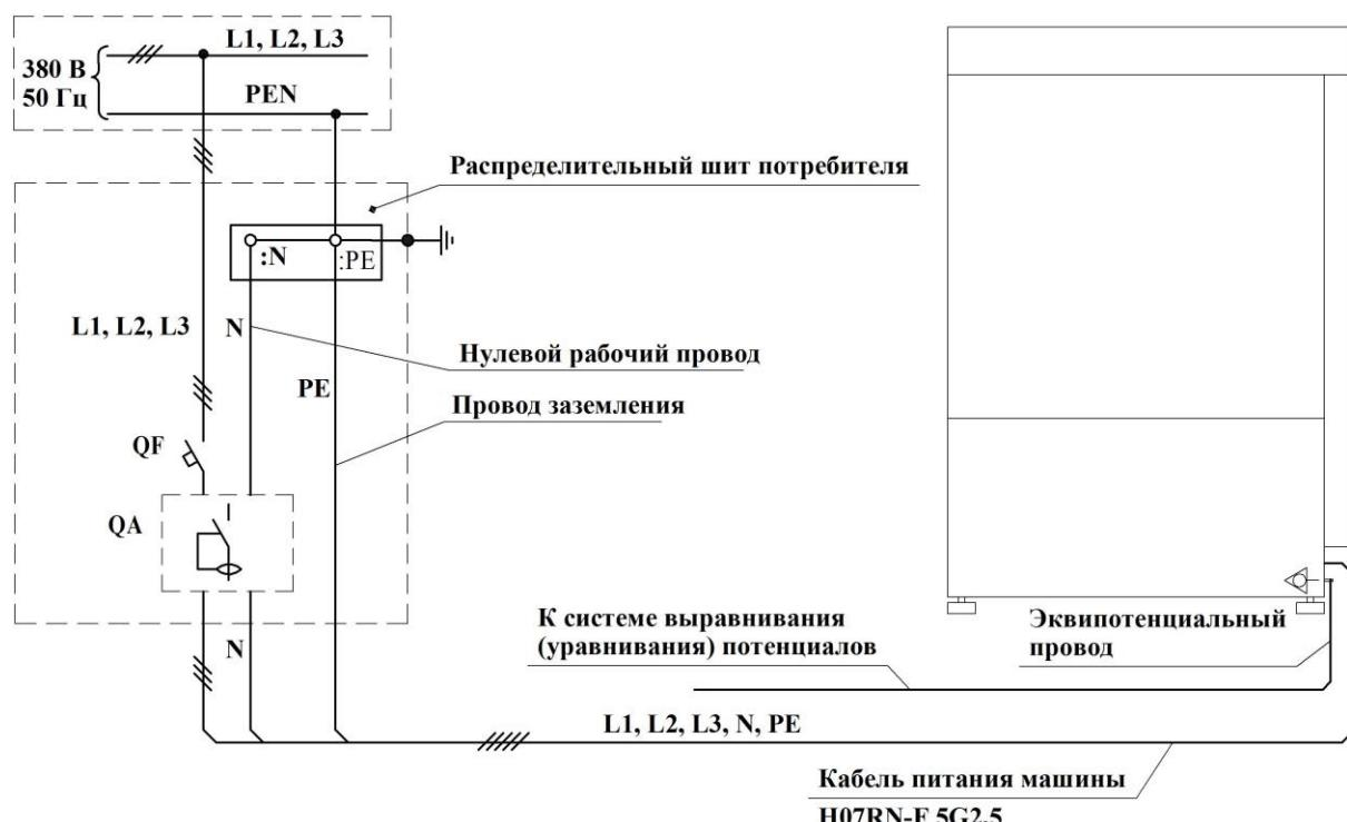
Рисунок 7 – Схема подключения к электрической сети
