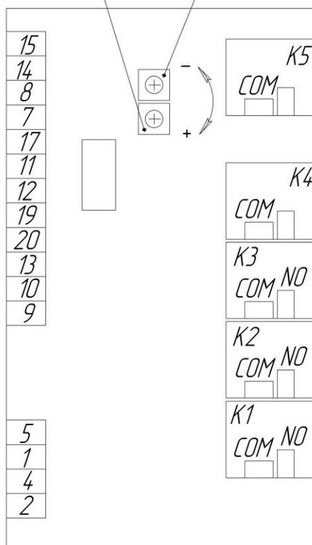
Рисунок 2 – Условное обозначение контактов блока управления
