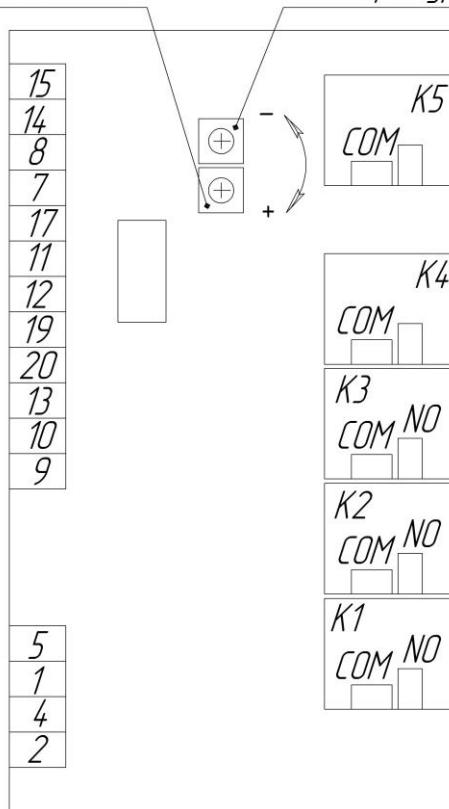
Рисунок 2 – Условное обозначение контактов блока управления
