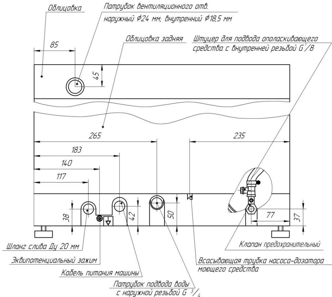
Рисунок 5 – Схема подвода коммуникаций к машине
