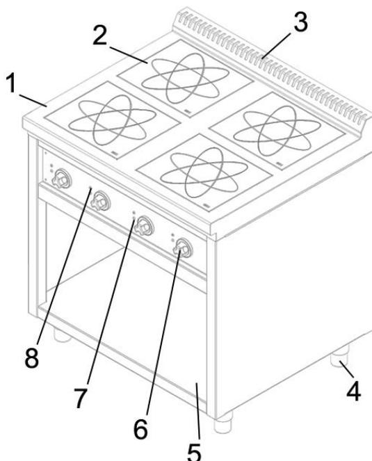
Рис. 1 Общее устройство индукционной плиты
