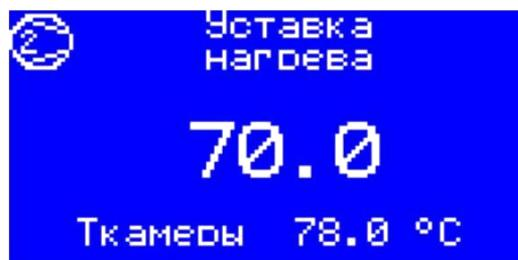
Рис. 7 - Экран изменения уставки температуры
