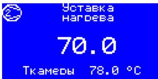
Рис. 7 - Экран изменения уставки температуры
