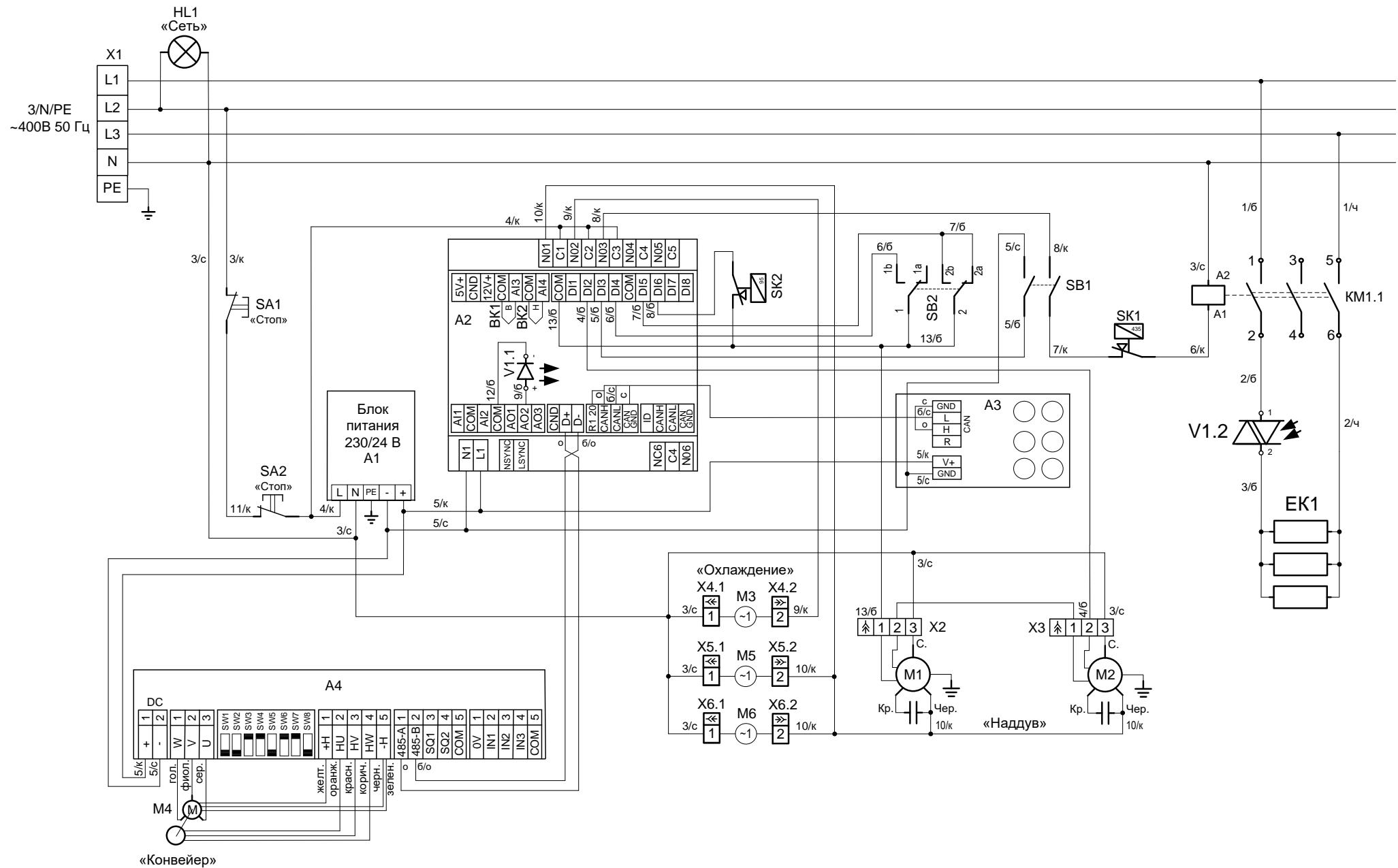
Рис. 16 - Схема электрическая принципиальная ПЭК-400 и ПЭК-400 с дверцей
