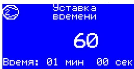
Рис. 8- Экран изменения уставки времени прохождения камеры
