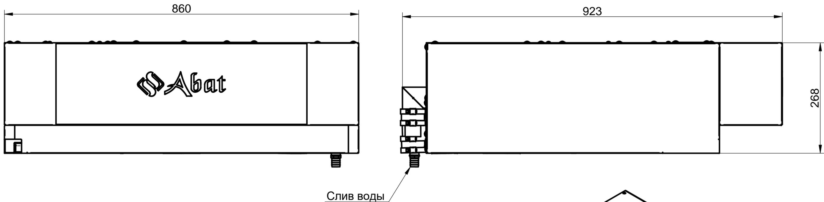
Зонты вытяжные встраиваемые с пароконденсатором ЗВВ-4-6/4ПМ для конвекционной печи КЭП-4ПМ/-01/-02 (далее - зонт) предназначен для вытяжки и конденсации отработанного пара конвекционной печи типа КЭП-4ПМ/-01/-02 на объектах общественного питания, а также очистки воздуха от аэрозолей жира, масла и производственных запахов в закрытых помещениях.
